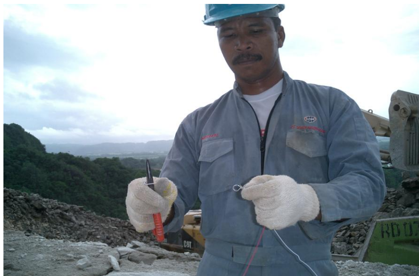
Gambar 2.11. Penyambungan kawat pada peledakan listrik (Quarry batugamping semen Bosowa, Makassar)
