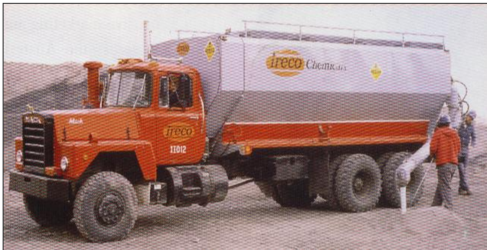
Gambar 2.5. Pengisian lubang ledak menggunakan MMU (Ireco Chemical, Canada)
