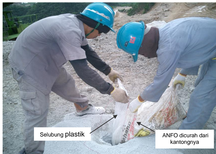
Gambar 2.4. Menuangkan ANFO ke dalam lubang ledak dan diselubungi plastik (Quarry batugamping semen Bosowa, Makassar)
